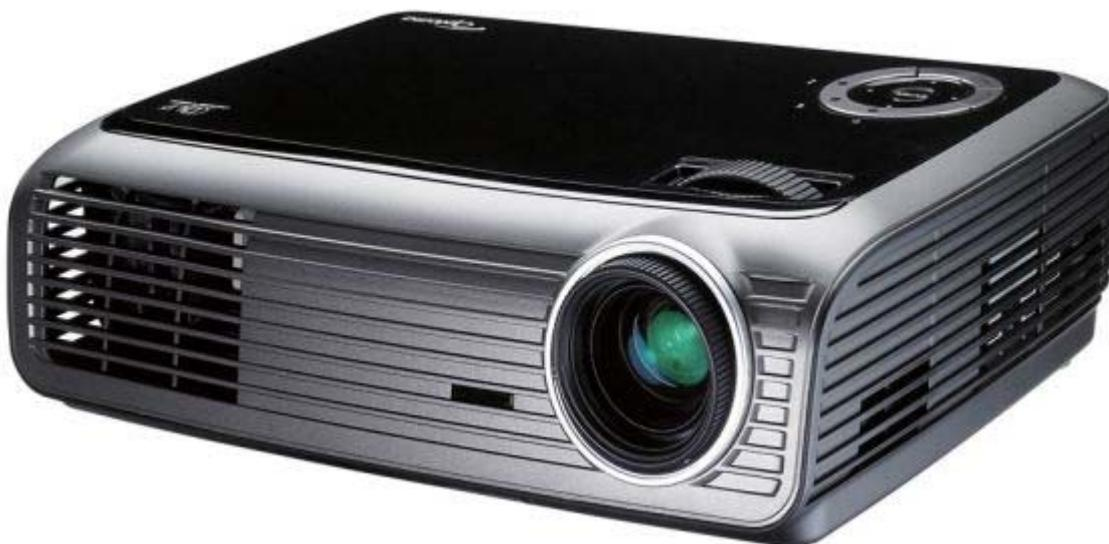
Der DS309i kurz vorgestellt: Der Optoma Standard-Portabel BrilliantColor DLP Projektor bietet 2300 Ansi-Lumen einen Kontrast von 2000:1 und eine SVGA 800 x 600 Auflösung. Bis zu 418 cm Bildbreite kann der Projektor gut ausleuchten durch die 2300 Ansi-Lumen. Bei Raumlicht sollte die Bildbreite aber am besten unter 279 cm liegen. Mit gerade mal 30 Dezibel gehört das Gerät zu den leiseren Projektoren. Das Modell wurde von Optoma 2008 gebaut und ist nicht mehr aktuell.
